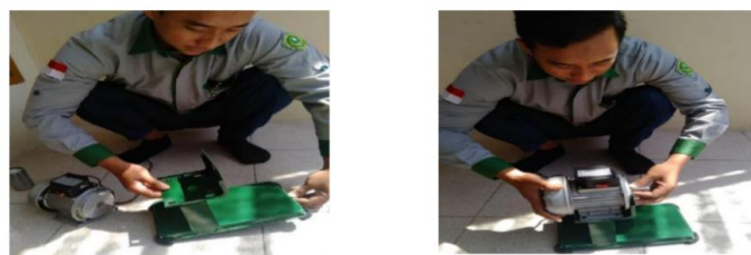
Gambar 8. Perakitan Dudukan Mesin dan Perakitan Dinamo
